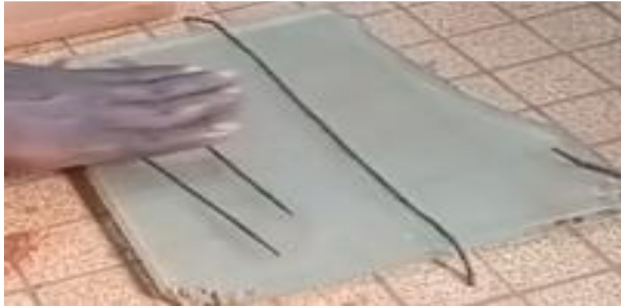
Photo n°6 : Plaque et spatule pour la mesure de la limite de plasticité des sols
