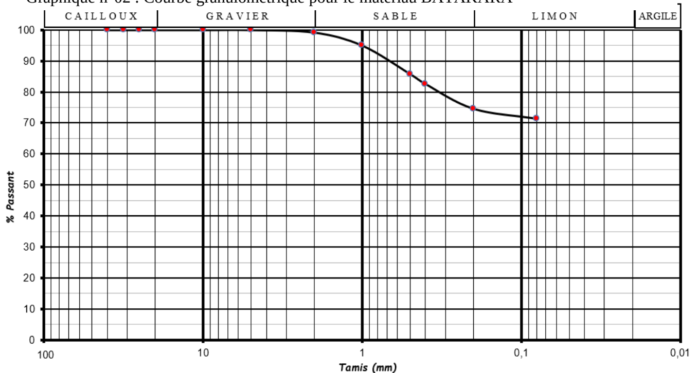
Graphique n°02 : Courbe granulométrique pour le matériau BATAKARA
