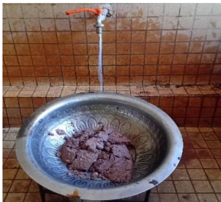
Photo n°07 : Échantillon de sol lavé et prêt pour l'analyse
