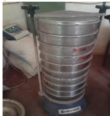
Photo n°1: Colonne de tamis utilisée pour le tamisage à sec.
